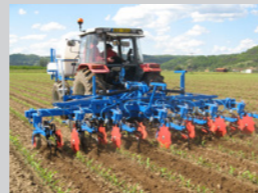
Désherbeuse 6 rangs avec guidage caméra
